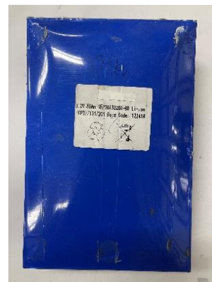
圖 2. 含鋰廢 UPS 樣品拆解後之鋰鐵電池單體外觀
