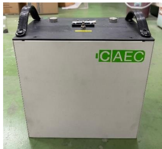
圖 1. 含鋰廢 UPS 樣品外觀
