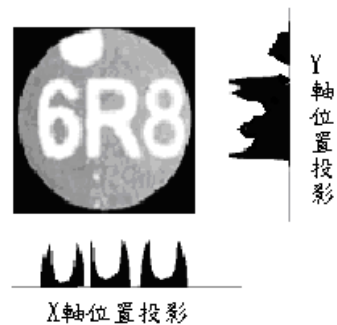
圖 12. 型號字元分別在 X 軸與 Y 軸之像素點投影圖
