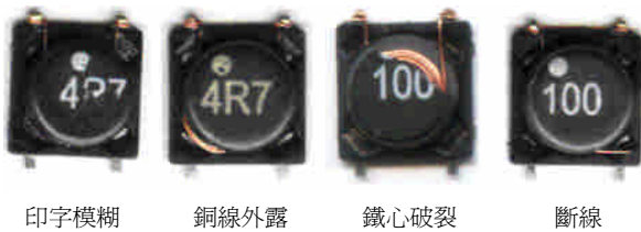
圖 3. 電感器之瑕疵種類
