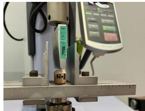
圖 6. 在陶瓷孔洞中添加奈米醫用樹脂進行抗壓檢測
