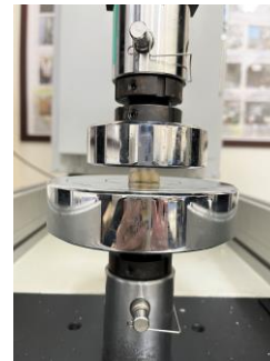
圖 19. 修補奈米醫用樹脂陶瓷假牙之試片進行抗壓檢測
