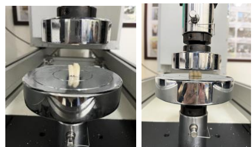
圖 7. (左) 未添加醫用樹脂之陶瓷假牙抗壓檢測 (右) 修補陶瓷假牙之抗壓檢測
