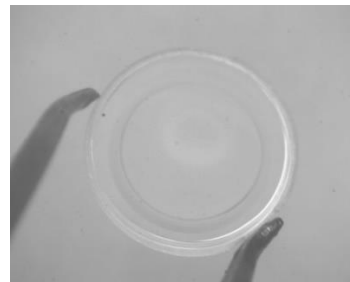
圖 11. 用遠心鏡頭取像的放大塑膠鏡片影像
