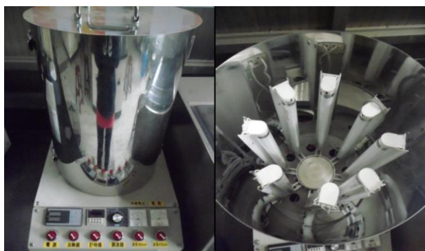
圖 2. 染料降解之實驗裝置
