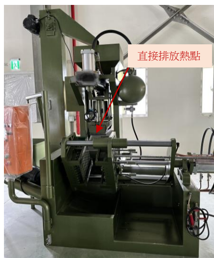
圖 4. 國產砂芯鑄造機範例及排放熱點示意圖
