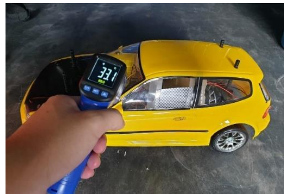
圖 17. 系統作動 3 分鐘後量測車室溫度
