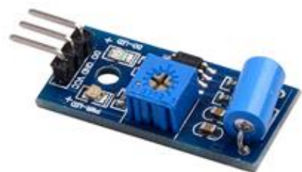
圖 7. SW-420 常閉型震動感測器模組
