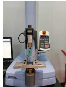
圖3. 三點彎曲檢測
