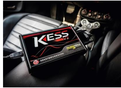
圖 3. OBD 寫入 ECU 控制程式
