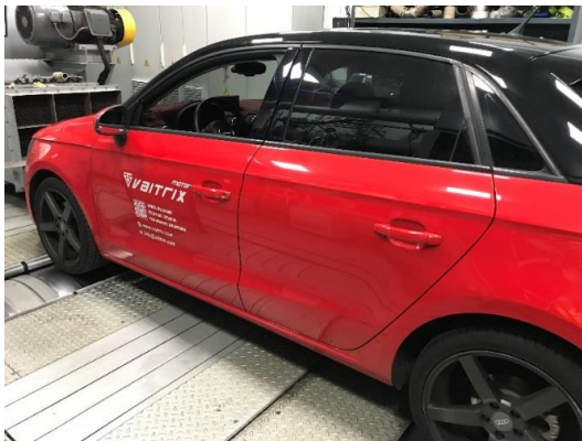
圖 7. 動力計與實驗車之安置
