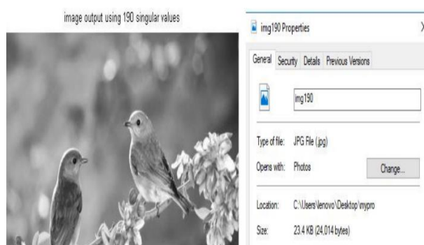
圖 5. 在對照片做 SVD 壓縮之後，容量縮小至 23.4 kb，且畫質不變，並額外附上是使用 190 個奇異值能擁有這樣的效果
