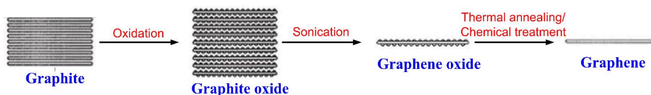
圖 1. 典型的類石墨烯材料化學還原法製程
