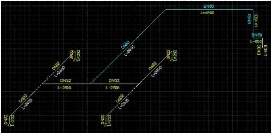
圖 5. 等角視圖管徑及管長 單位：mm
