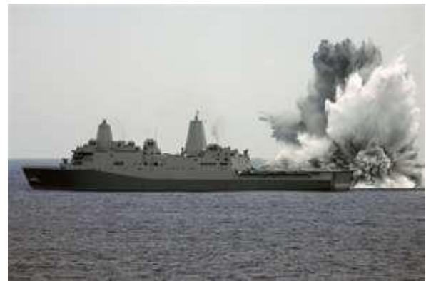
圖 1. 水下爆炸所產生的水柱 (Water plume) [22]
