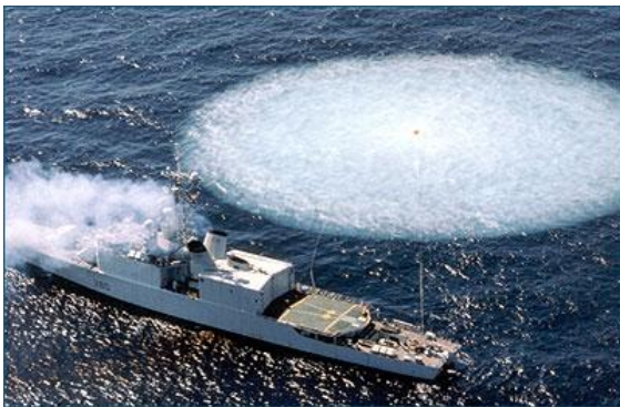
圖 3. 白色區域為震波在自由液面反射所導致巨大空蝕區[21]
