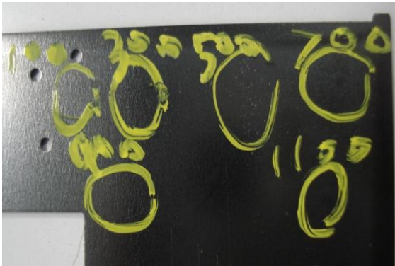
圖 6. 鍍 1\mu\text{m} 類鑽碳膜 304 不鏽鋼試片於 RCA 耐磨測試機上磨耗
