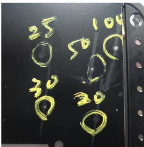
圖 7. 塗黑色烤漆 304 不鏽鋼試片於 RCA 耐磨測試機上磨耗
