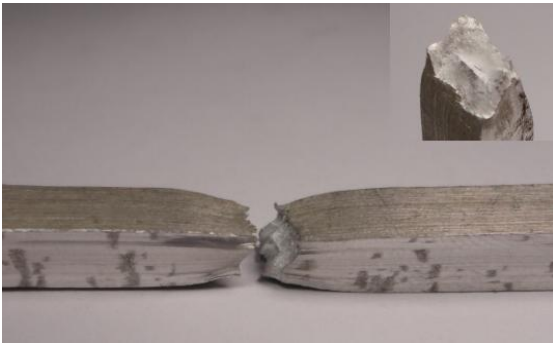
圖 5. T 方向拉伸試驗之破斷面巨觀觀察
