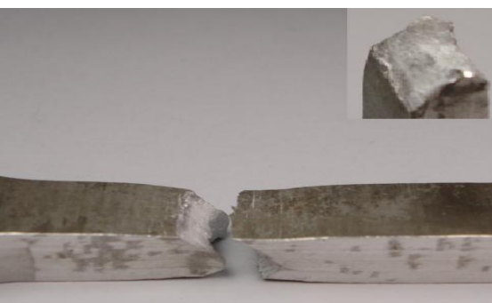
圖 6. L 方向拉伸試驗之破斷面巨觀觀察
