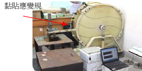
圖13. 實驗架設實際圖
