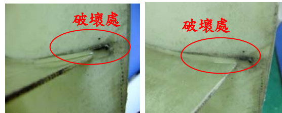
圖19. 小 S 型葉面尾端與圓盤接縫處脫層現象
