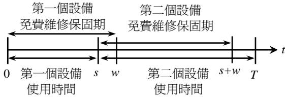
圖 2 在  $0 \leq s \leq w$  下設備的置換維修模式
