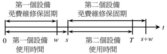
圖 4 在  $T-w \leq s \leq T$  下設備的置換維修模式
