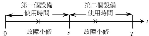
圖 1 設備的置換維修模式
