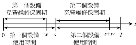
圖 3 在  $w \leq s \leq T-w$  下設備的置換維修模式
