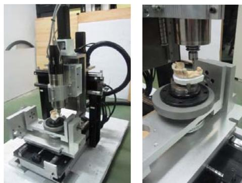
圖 10. 石膏牙模固定於五軸機台示意圖
