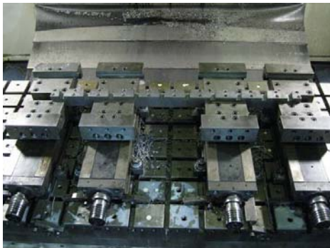
圖 2. 夾持長工件所需虎鉗數多，校準平行度更加困難
