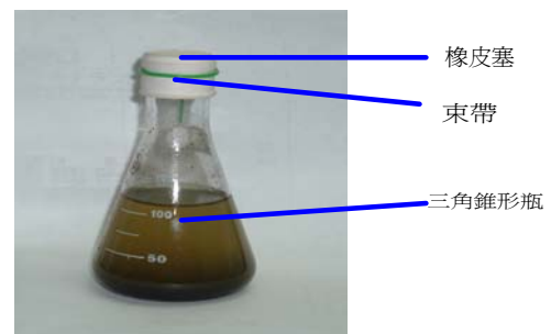
圖 1. 批次試驗儀器設備示意圖
