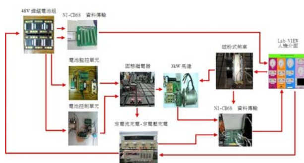
圖 8. 鋰電池診斷管理動態測試架構圖
