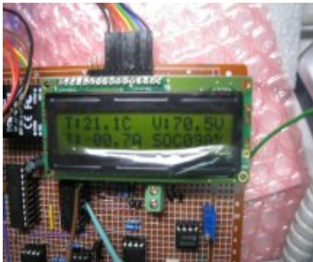
圖 15. 電池殘電量顯示器測試顯示圖
