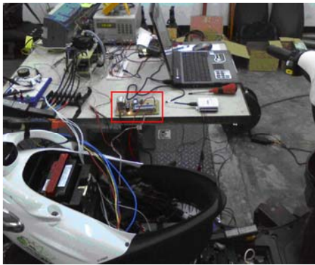
圖 18. 電池殘電量顯示模組實測 (二)
