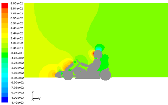
圖 10. 舊模型中心切面之壓力分布 (單位: Pa)
