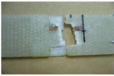
圖 57. 手積法修補後破壞情況
