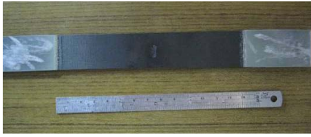
圖 63. 為碳纖預浸材之實驗試片
