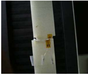
圖 53. 手積法雙邊裂縫破壞情形
