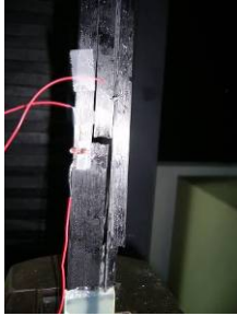
圖 64. 碳纖預浸材破壞情況
