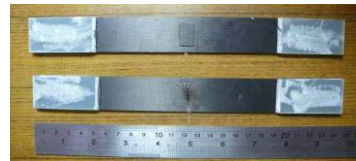
圖 24. 碳纖預浸材試片示意圖
