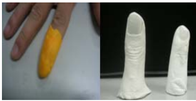
圖 7. 聚矽氧烷矽膠取模結果
