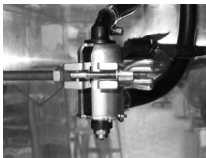
圖 2. 新型噴油嘴總成組成實物照片
